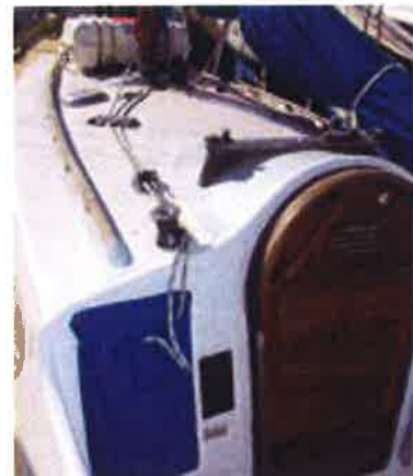
Der gewölbte Niedergang ohne Schiebeluk sollte mehr Stabilität und Schutz gegen Schwallwasser bieten
