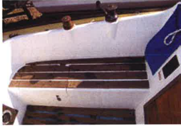
Das Cockpit ist tief und bietet der Crew guten Schutz. Durch die Teakgrätungs bleiben die Duchten trocken und bieten guten Stand
