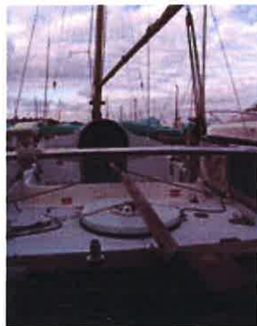
Der Ruderkopf mit durchgesteckter Pinne. Unter dem runden Deckel befindet sich weiterer Stauraum
